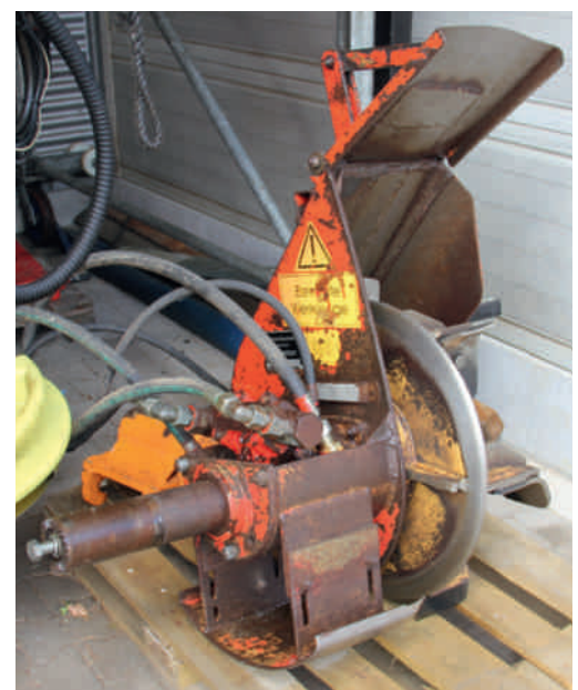
Der Einsatz von Grabenfräsen ist zu vermeiden.
