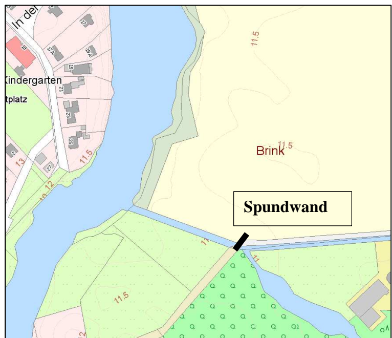
Abb.6.1-4: Einbau einer Spundwand zur Abtrennung des Grundwasserzuflusses im Zulauf aus dem Waldsee in Varste
